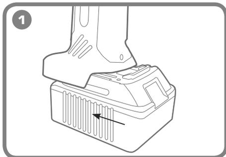
**1** Вставьте аккумулятор в корпус инструмента до щелчка, при этом прозвучит характерный сигнал и сработает световая индикация. Аккумулятор устанавливается только в одном положении.
